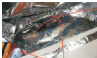
Middelste folie wordt met een lijm afgesloten
